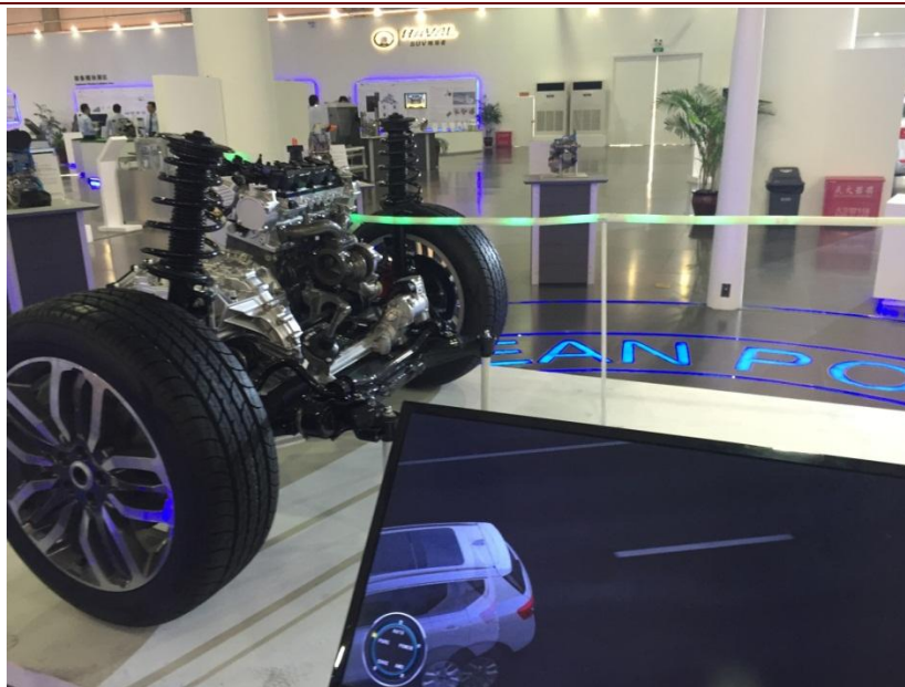
图表 6: 长城汽车 H7L (PHEV) 前桥由内燃机驱动
