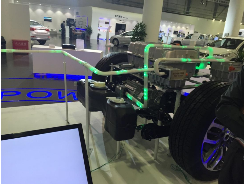
图表 7：长城汽车 H7L (PHEV) 后桥由电机驱动
