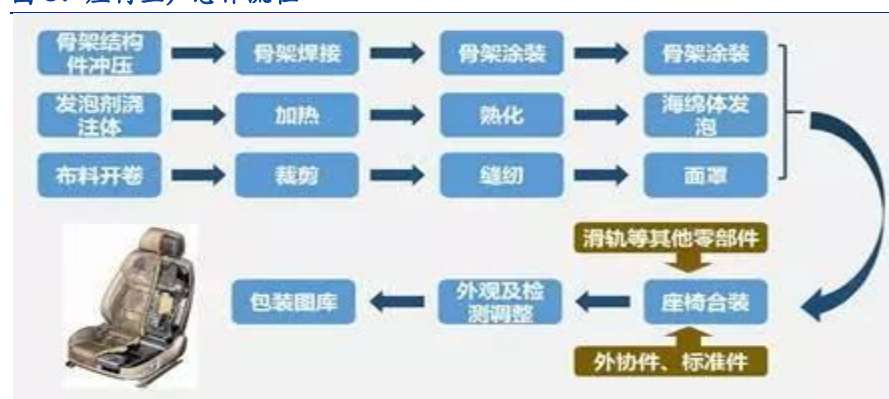
图 8：座椅生产总体流程
