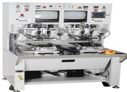
图 39：联得装备的 FPC 绑定机
