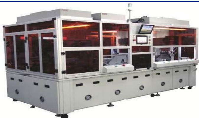
图 42：联得装备的 OCA 全自动贴合设备
